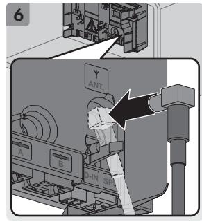
**en** Mounting the antenna bracket **es** Montaje del ángulo de la antena **fr** Montage de l'équerre d'antenne
