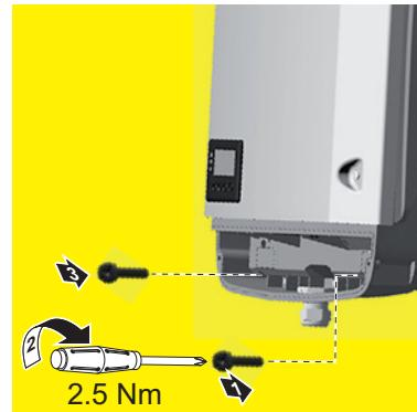
¡Poner el inversor únicamente en servicio con los tornillos de fijación apretados!
